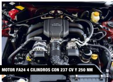
MOTOR FA24 4 CILINDROS CON 237 CV Y 250 NM
